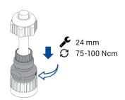
Verschrauben Sie das Gehäuse mit dem Kontaktträger.
