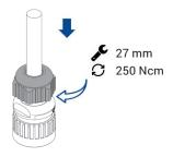
Verbinden Sie die Kabelverschraubung mit dem Gehäuse.
