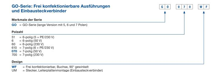
FAV M = Stecker mit oktagonalem Flansch (Einbausteckverbinder) FA M = Stecker mit rechteckigem Flansch (Einbausteckverbinder)
