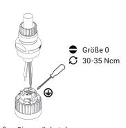
Schließen Sie zunächst den Schutzleiter über die Schraubverbindung am Kontaktträger an.
