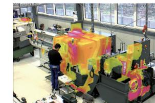
Thermal Radiometrie (TR):Automatischer Alarm bei Über- oder Unterschreiten von definierten Temperaturgrenzen
