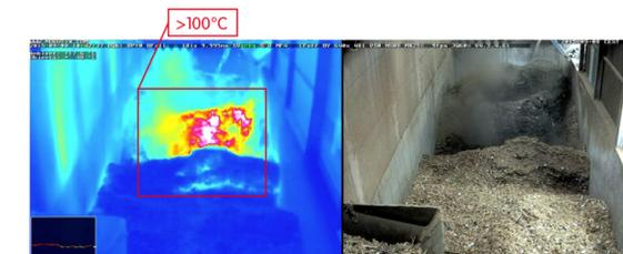
MOBOTIX Dual-Thermalkameras bieten Thermal Overlay, um sogenannte „Hotspots“ im sichtbaren Bild zu identifizieren und größere Schäden zu vermeiden
